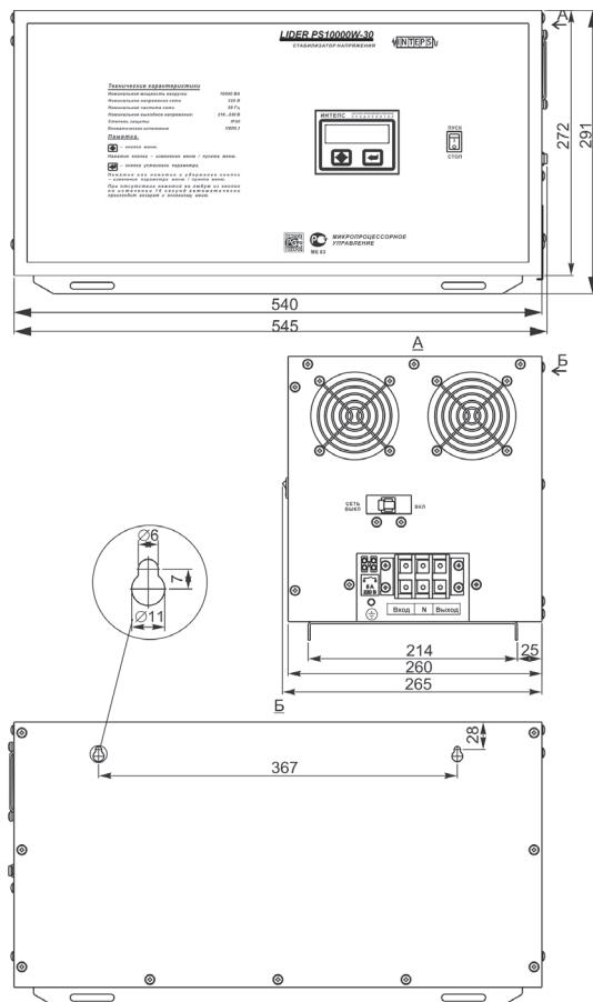
Габаритные и установочные размеры стабилизаторов напряжения переменного тока:
