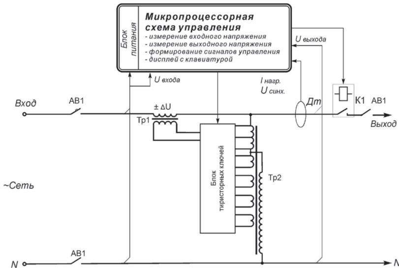
В стабилизаторах этой модели регулирование напряжения осуществляется за счет ступенчатого переключения по двоичному цифровому коду последовательно соединенных с помощью силовых ключей вольтодобавочных секций обмоток регулирующего трансформатора. Такое схемотехническое решение позволило предложить рынку ступенчатый стабилизатор с исключительно плавной регулировкой выходного напряжения – дискретность регулирования составляет 0,6 В.
