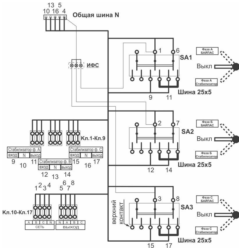
Схема подключения щита коммутации с ручным
