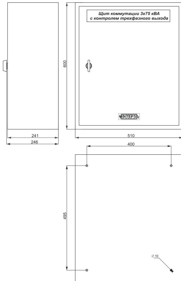
Габаритные и установочные размеры щита коммутации с контролем трехфазного выхода для стабилизаторов напряжения мощностью от 22,5 кВА до 225 кВА
