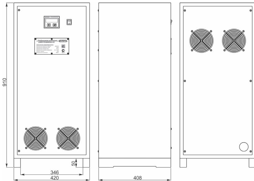
Габаритные и установочные размеры стабилизаторов напряжения переменного тока:
