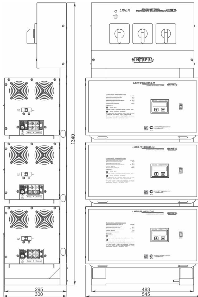
Габаритные и установочные размеры трехфазного стабилизатора на базе стойки 9-36 с ручным байпасом и контролем трехфазного выхода.
