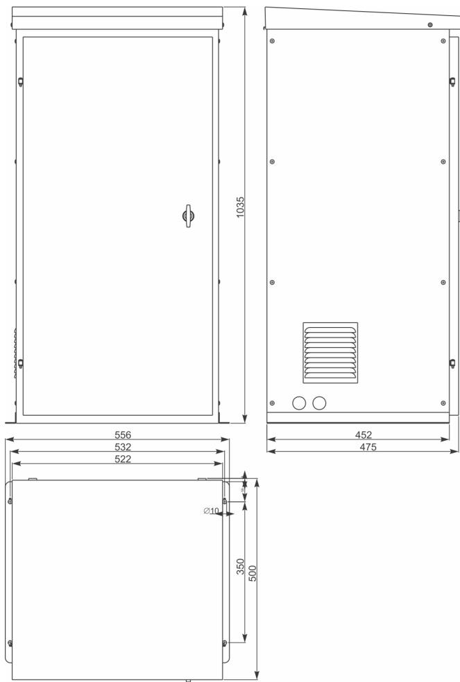
Габаритные и установочные размеры металлического шкафа для однофазных стабилизаторов напряжения переменного тока мощностью от 7,5 кВА до 30 кВА
