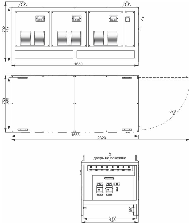
Габаритные и установочные размеры стабилизаторов напряжения переменного тока
