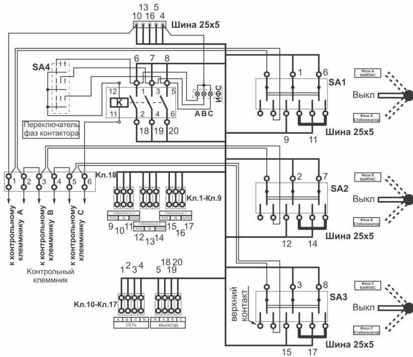
Схема подключения щита коммутации с ручным
