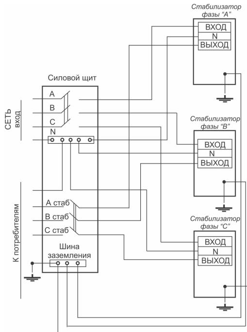
Схема подключения стабилизаторов напряжения переменного тока
