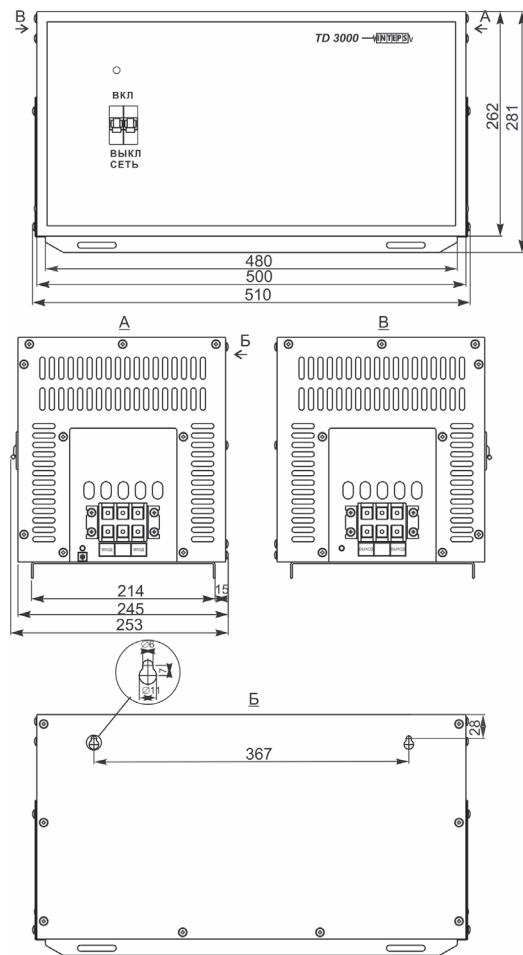
Габаритные и установочные размеры разделительных трансформаторов
