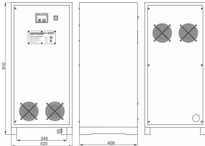
Габаритные и установочные размеры стабилизаторов напряжения переменного тока: LIDER PS15000W-+30/-50, LIDER PS20000W-15(30, +30/-50), LIDER PS30000W-15(30).
