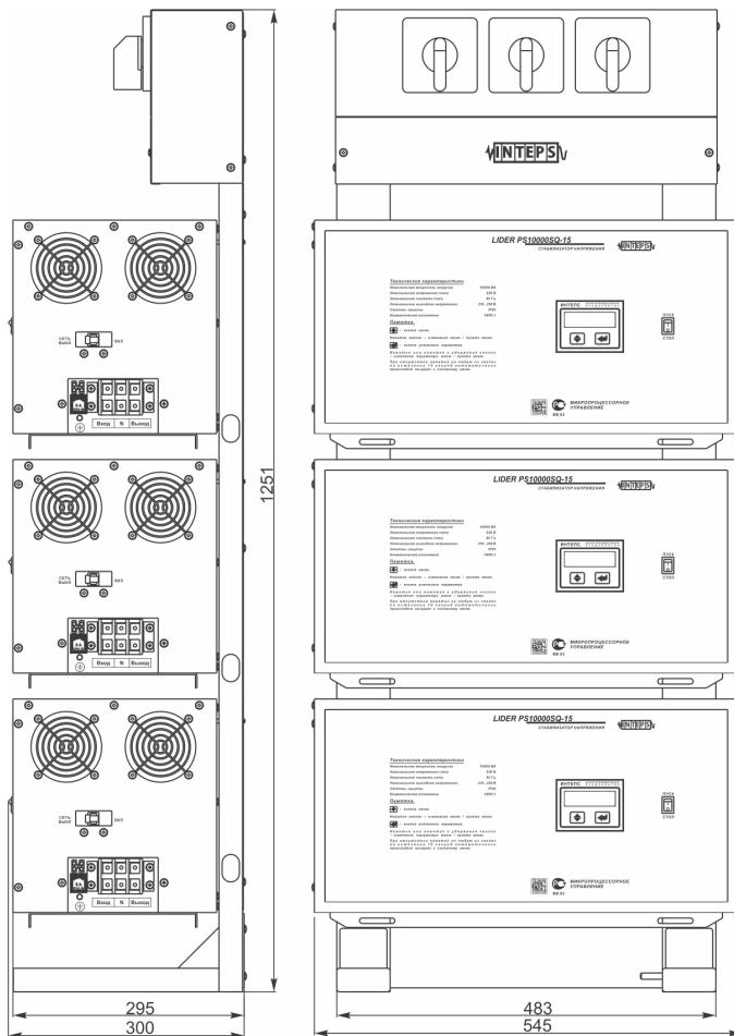
Габаритные и установочные размеры трехфазного стабилизатора
