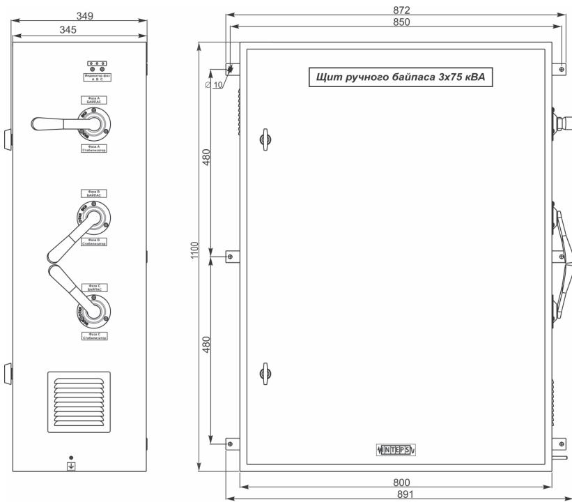
Габаритные и установочные размеры щита коммутации с ручным байпасом по каждой фазе без контроля трехфазного выхода для стабилизаторов напряжения мощностью от 150 кВА до 225 кВА
