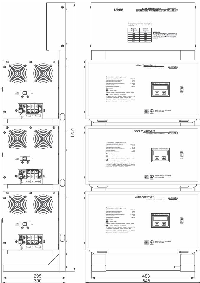
Габаритные и установочные размеры трехфазного стабилизатора на базе стойки 9-36 без контроля трехфазного выхода.
