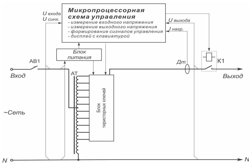
с тем, чтобы обеспечить на выходе напряжение 220 В ± 4,5 %. Все переключения ключей осуществляются без прерывания питания нагрузки и без искажения формы синусоиды, в режиме, наиболее безопасном для подключенных к стабилизатору устройств.
