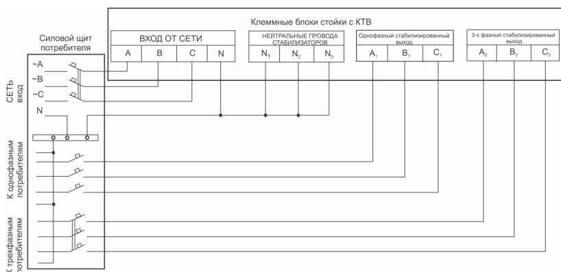
Схема подключения к трехфазной сети стабилизаторов напряжения переменного тока со стойкой с КТВ.
