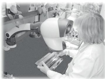
нагрева. На втором этапе происходит навесной монтаж более крупных элементов. По завершению этих этапов контролёры ОТК на оптической установке контроля проверяют качество монтажа и пайки на отсутствие дефектов. После каждой операции сборки на плату наклеивается этикетка с фамилией сборщицы. Полностью собранные и проверенные платы проходят ещё один этап контроля – стендовый. На специальном стенде, разработанном конструкторами
