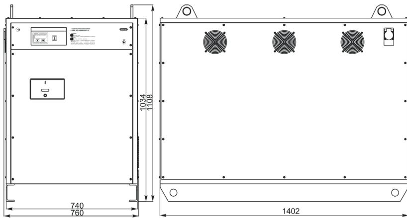
Габаритные и установочные размеры стабилизаторов напряжения переменного тока:
