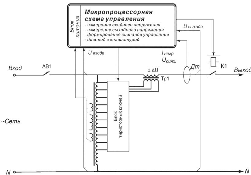
Для обеспечения вывода информации о работе стабилизатора и изменения регулируемых параметров все стабилизаторы имеют цифровой светодиодный дисплей с 2-х кнопочной клавиатурой. Клавиатура дисплея позволяет вывести на экран информацию о величине входного и выходного напряжений стабилизатора, о мощности, подключенной к стабилизатору нагрузки, температуре силовых ключей. С помощью клавиатуры производится также установка требуемого выходного напряжения
