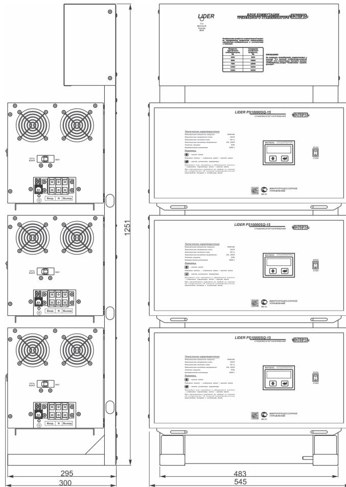
Габаритные и установочные размеры трехфазного стабилизатора
