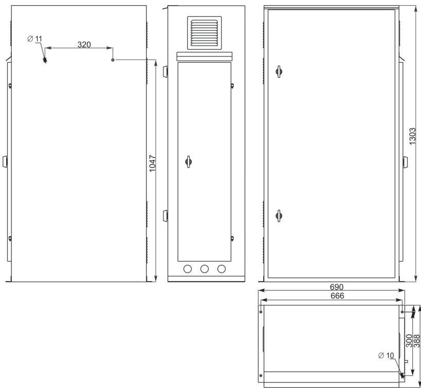
Габаритные и установочные размеры металлического шкафа для трехфазных стабилизаторов напряжения переменного тока мощностью от 9 кВА до 36 кВА
