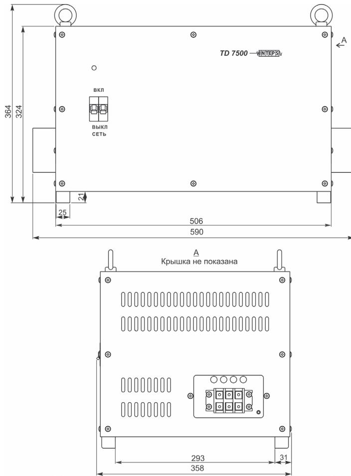
Габаритные и установочные размеры разделительных трансформаторов
