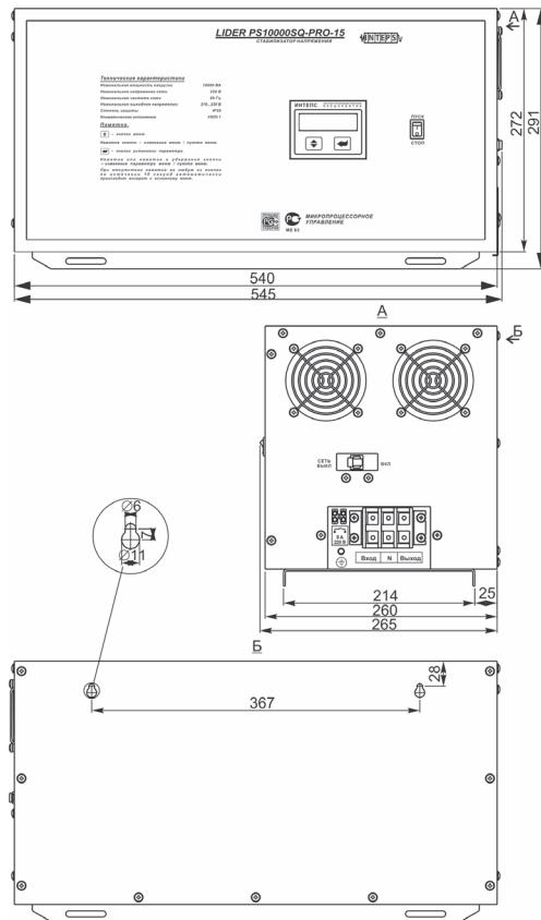
Габаритные и установочные размеры стабилизаторов напряжения переменного тока:
