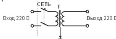
Использование заземляющего контура между первичной и вторичной обмотками предотвращает появление между цепями переменного тока емкостных связей, что повышает степень изоляции от первичной цепи.
