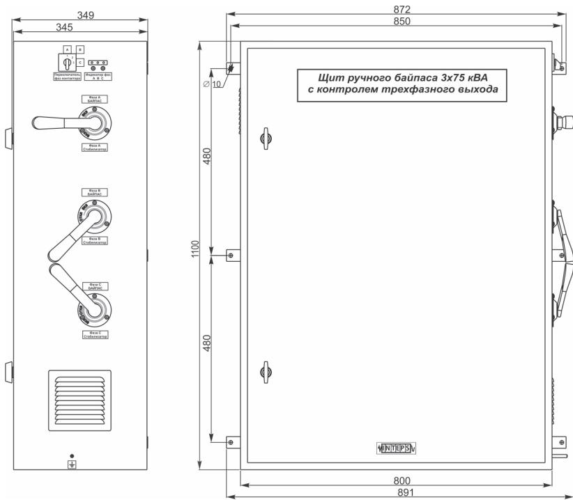
Габаритные и установочные размеры щита коммутации с ручным байпасом по каждой фазе и контролем трехфазного выхода для стабилизаторов напряжения мощностью от 150 кВА до 225 кВА
