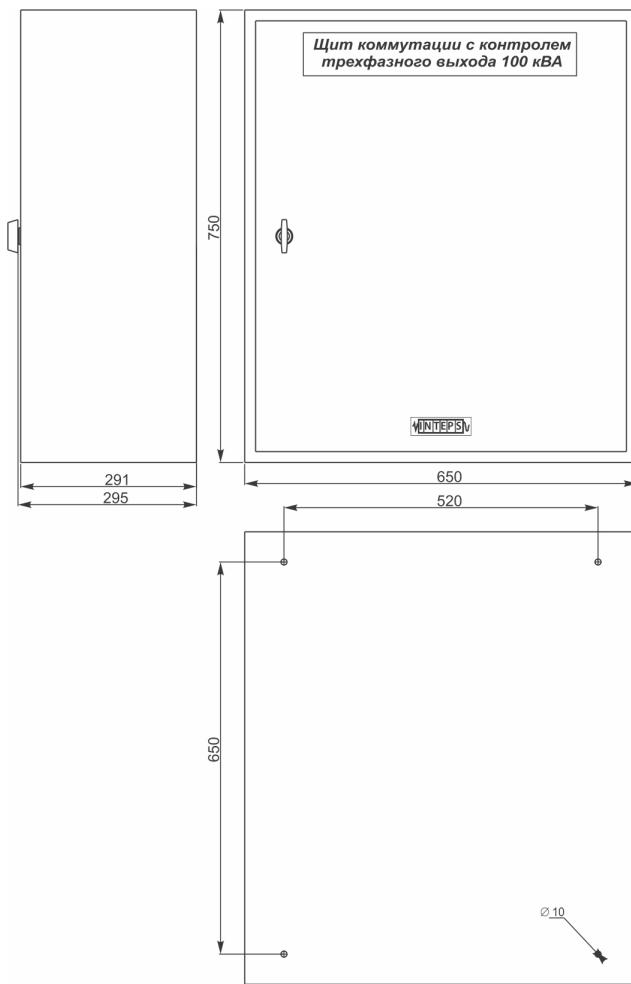
Габаритные и установочные размеры щита коммутации с контролем трехфазного выхода для стабилизаторов напряжения мощностью 300 кВА
