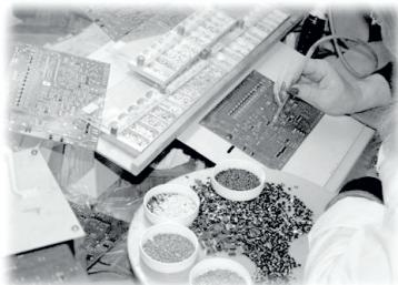
использованием технологии поверхностного монтажа. На первом этапе радиоэлементы для поверхностного монтажа наносятся на плату, покрытую паяльной пастой, и плата отправляется в тунNELьную печь с поэтапным контролем температуры в трёх зонах
