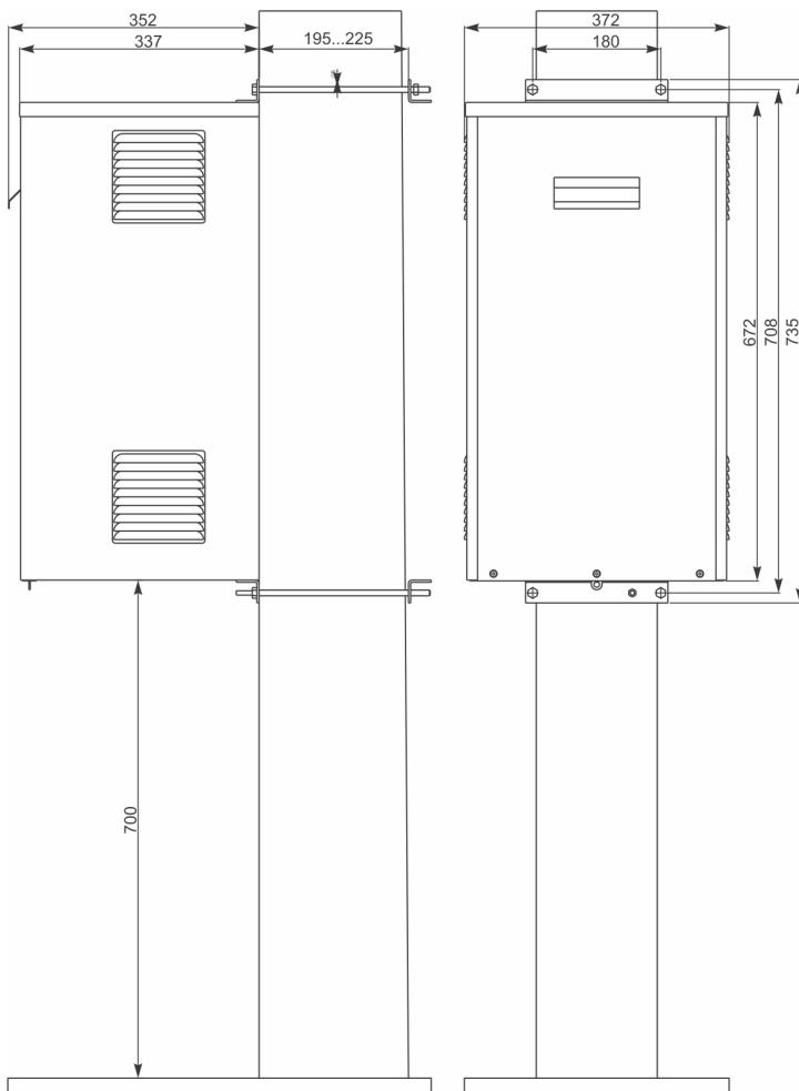
Габаритные и установочные размеры металлического шкафа для однофазных стабилизаторов напряжения переменного тока мощностью от 3 кВА до 12 кВА
