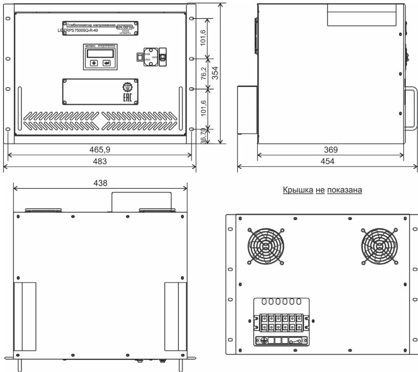
Габаритные и установочные размеры стабилизаторов напряжения переменного тока:
