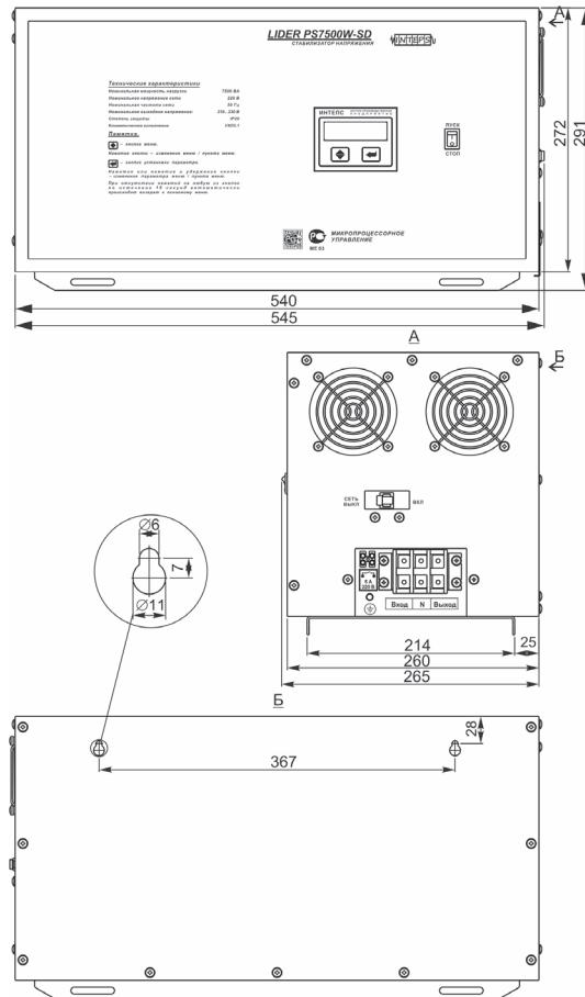
Габаритные и установочные размеры стабилизатора напряжения переменного тока:
