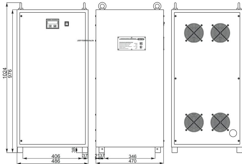
Габаритные и установочные размеры стабилизаторов напряжения переменного тока:
