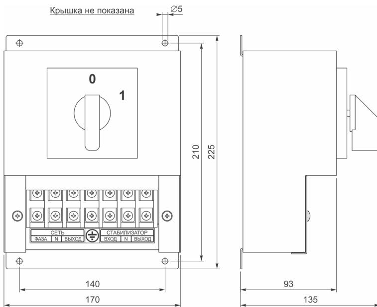
Габаритные и установочные размеры байпаса однофазного ручного LIDER B1/3-12
