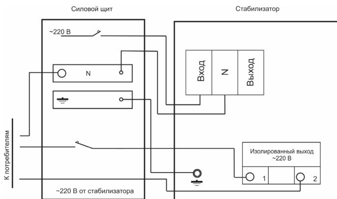
Схема электрических соединений при подключении нагрузки к гальванически изолированному выходу.
