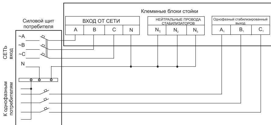
Схема подключения к трехфазной сети стабилизаторов напряжения переменного тока со стойкой.
