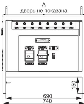
Габаритные и установочные размеры стабилизаторов напряжения переменного тока LIDERINT PS45SQ-S-15(25), LIDERINT PS63SQ-S-15(25), LIDERINT PS100SQ-S-15(25), LIDERINT PS150SQ-S-15(25), LIDERINT PS225SQ-S-15(25).
